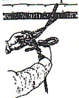
Рис. 3 «в». Закрепление спасательной веревки за конструкцию третьим способом
